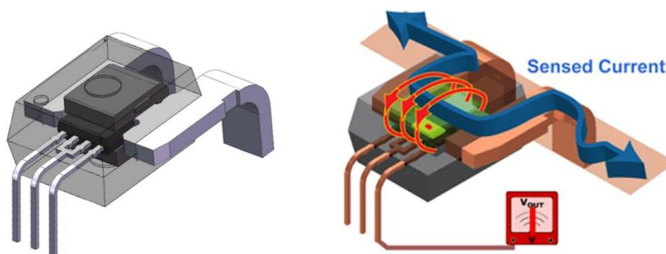
AH950 是专为大电流检测应用开发的开环式高精度线性电流传感器芯片。内置  $0.1\text{m}\Omega$  的初级导体电阻，有效降低芯片发热支持大电流检测： $\pm 50\text{A}$ ， $\pm 100\text{A}$ ， $\pm 150\text{A}$ ， $\pm 200\text{A}$ 。其内部集成独特的温度补偿电路以实现芯片在  $-40$  到  $125^\circ\text{C}$  全温范围内良好的一致性。出厂前芯片已做好灵敏度和静态（零电流）输出电压的校准，在全温度范围内提供  $\pm 2\%$  的典型准确性。
