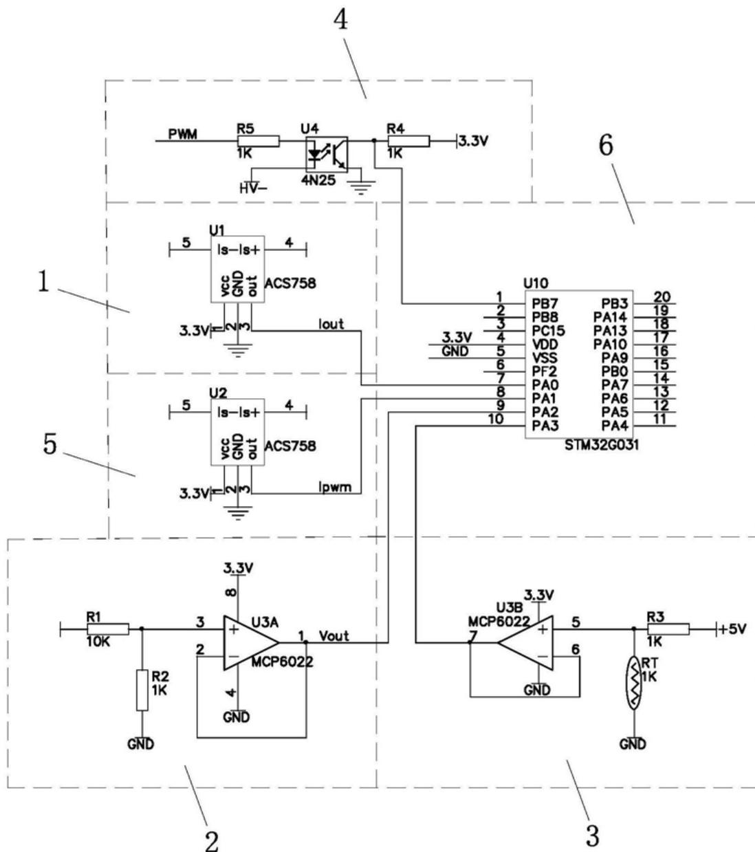
开关电源输出电流检测模块 1 采用芯片型号为 ACS758（或使用国产芯片 AH950）的电流传感器 U1，电流传感器 U1 的第 4 引脚作为检测电流输入端，第 5 引脚作为检测电流输出端，第 3 引脚作为所述开关电源输出电流检测模块 1 的检测信号输出端与所述处理器 6 连接。开关电源输出电压检测模块 2 包括有电阻 R1、电阻 R2、以及型号为 MCP6022 的运算放大器 U3A，电阻 R1 一端作为开关电源输出电压检测模块 2 的电压输入正极连接端用于与开关电源的电压输出正极连接端连接，电阻 R1 另一端与电阻 R2 一端、运算放大器 U3A 同相输入端相连接，电阻 R2 另一端作为开关电源输出电压检测模块 2 的电压输入负极连接端用于与开关电源的电压输出负极连接端连接，运算放大器 U3A 的反相输入端与运放输出端连接后作为开关电源输出电压检测模块 2 检测信号输出端与处理器 6 连接。
